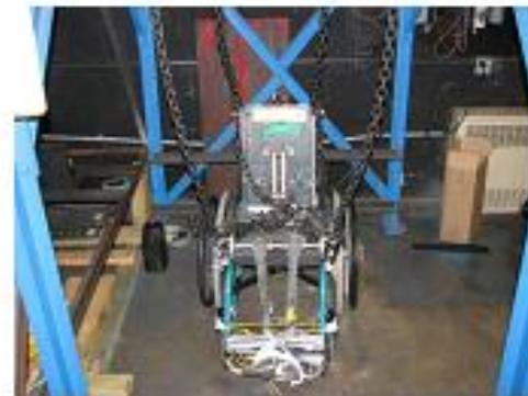
(d) A MWC set up on the CDT machine
